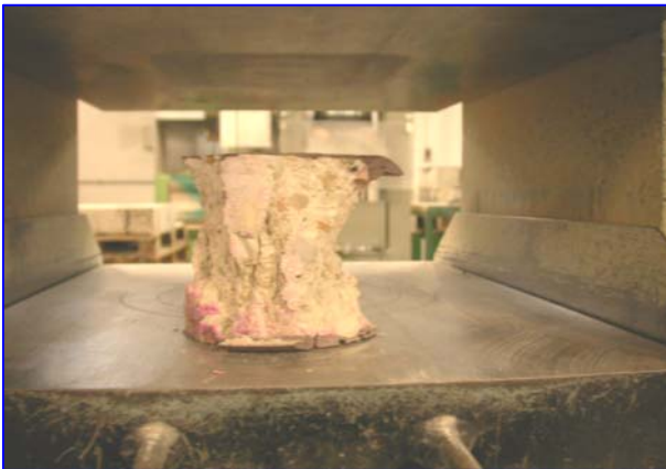
Parte finale della prova di compressione su carota in cls estratta da pilastro P4.
