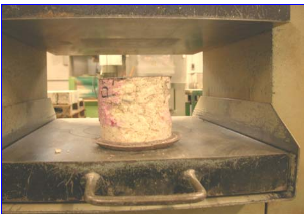
Parte finale della prova di compressione su carota in cls estratta da pilastro P5.
