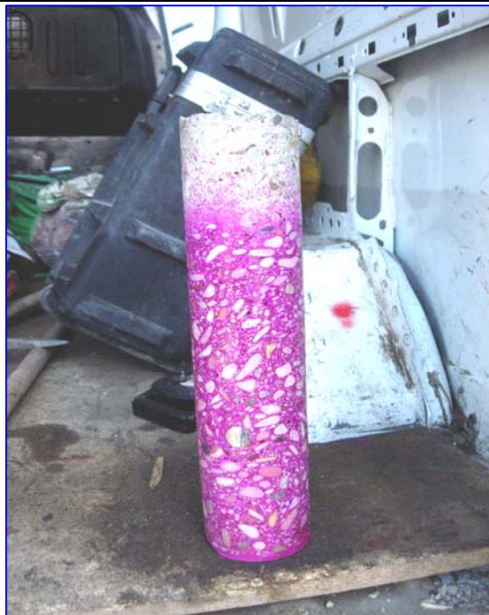
Determinazione della profondità di carbonatazione su carota in cls in sito.
