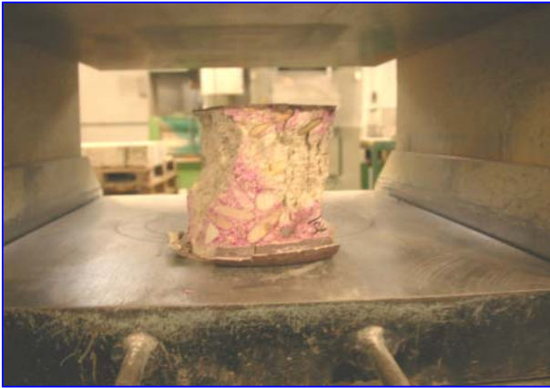
Parte finale della prova di compressione su carota in cls estratta da pilastro P1 (parte bassa).
