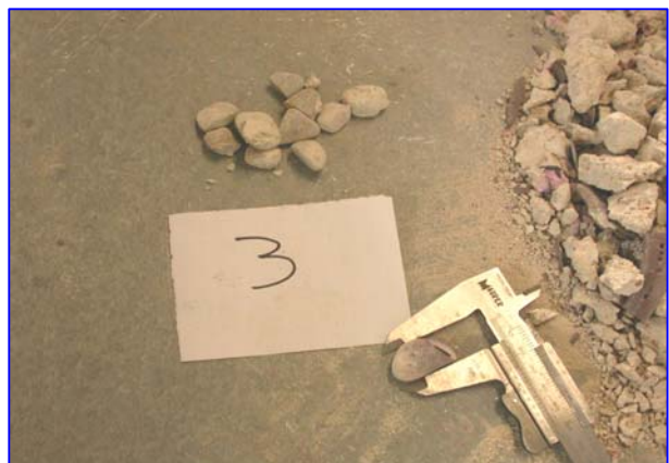
Misurazione grandezza inerti ricavati da carota in cls estratta da pilastro P5.
